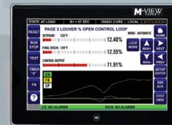
1. Monitores táctiles a todo color Serie M-View™ con pantalla brillante y luz de fondo
