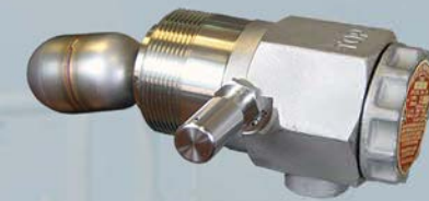
12. Interruptor de nivel MLS-020 controla sobrellenado de líquido de separadores, con montaje directo al tanque
