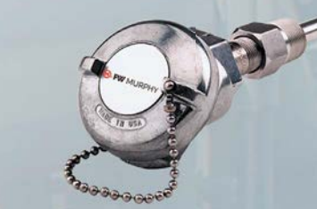
17. Conjuntos para Termopar J o K sin aterrizar, elemento de porcelana incluye termopozo de acero inoxidable
